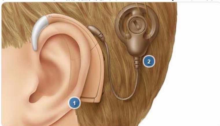
圖三 人工電子耳配戴示意圖：1. 指向性麥克風（有些廠牌於此會附上小型的語言處理器）2. 傳送感應線圈。(5)
