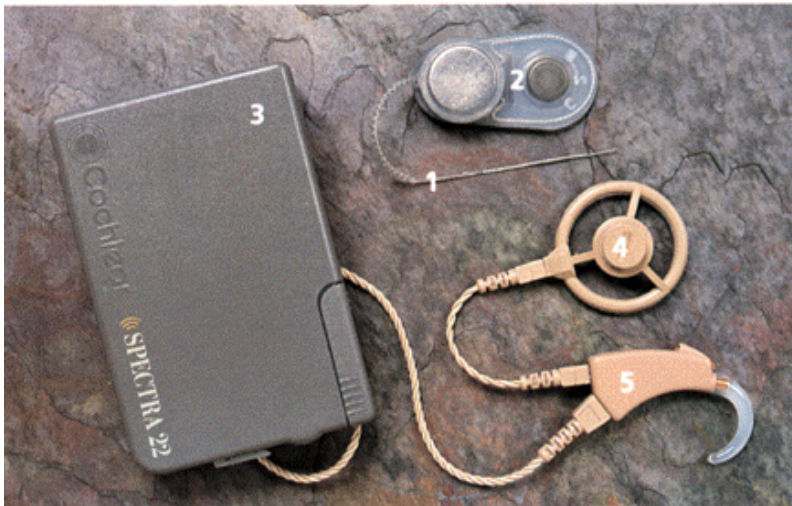
圖二 人工電子耳（Model: Cochlear Nucleus 22）：1. 多頻道電極（Multi-channel Electrodes）2. 接受感應線圈(Receiver Coil)及刺激器(Stimulator) 3. 語言處理器（Speech Processor）4. 傳送感應線圈 (Transmitter Coil) 5. 指向性麥克風（Directional Microphone）。(4)
